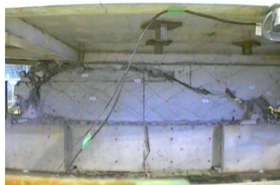
شکل ۱۲ فروریزش دیوار و طبقه اول تحت بارگذاری‌های بعدی
