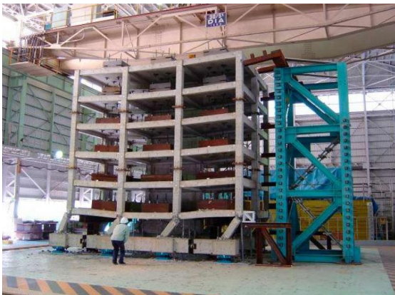
شکل ۱۲ فروریزش دیوار و طبقه اول تحت بارگذاری‌های بعدی
