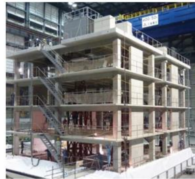
ب) ساختمان ۴ طبقه بتن‌آرمه تست شده در E-Defense ژاپن (۲۰۱۵)
